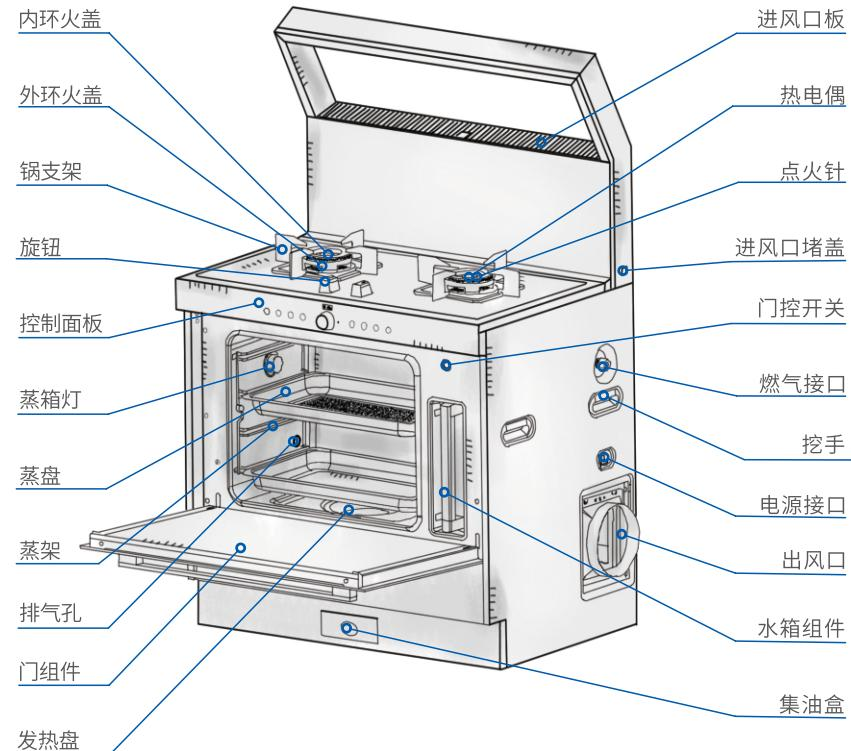
双气玻璃款(蒸箱)结构示意图
