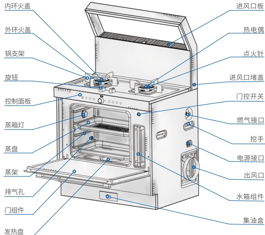
双气不锈钢款(蒸箱)结构示意图
