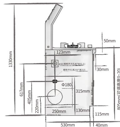
图二 燃气管、烟管电源线开孔尺寸
