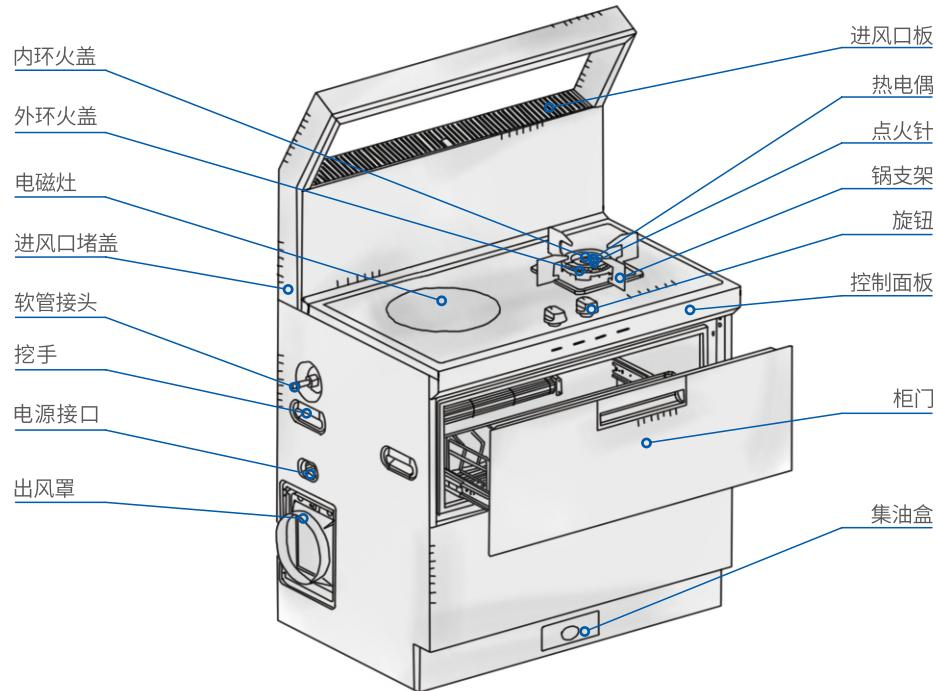
气电玻璃款结构示意图
