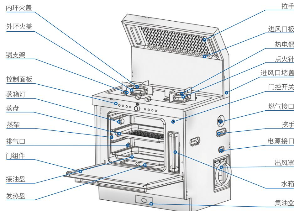
双气不锈钢款(蒸箱)结构示意图
