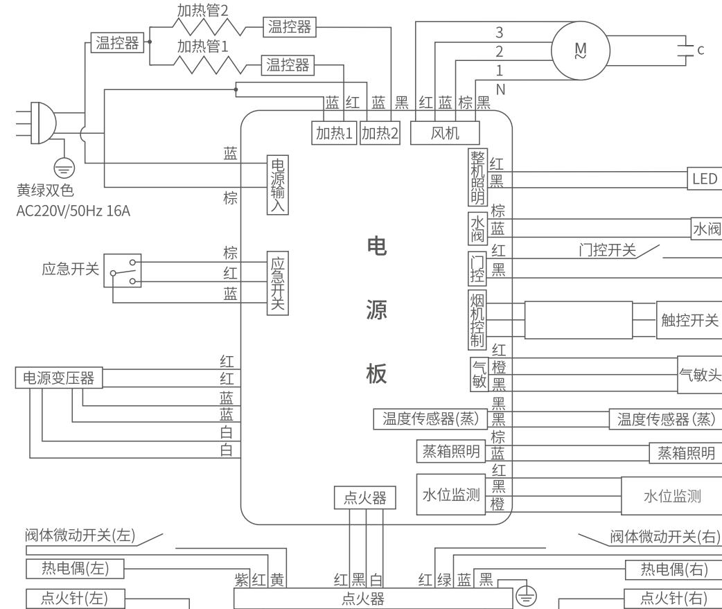
双气不锈钢款(蒸箱) 电路接线图 双气玻璃款(蒸箱) 电路接线图
