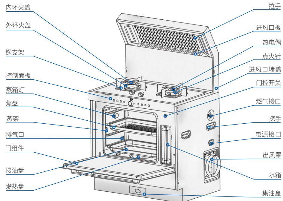
双气不锈钢款蒸箱结构示意图
