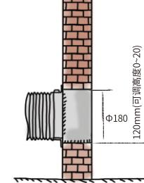
图四 侧板墙面孔位图
